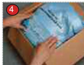
**4** Einen zweiten Beutel aktivieren und oben auf das Produkt legen. Die Kartonklappen schließen, so dass der Schaum sich zu einem Oberpolster ausdehnt.
